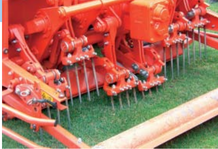
Der TerraSpike vermag auch tiefe Verdichtungen zu lockern
