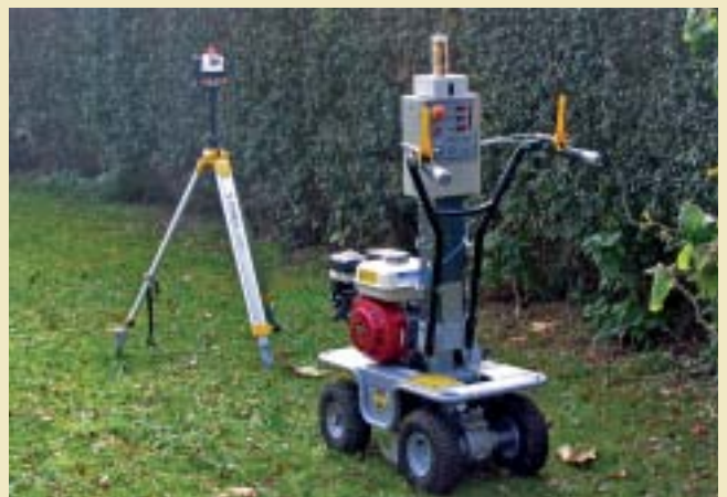
Eine Lasereinheit im Gelände sowie ein Empfänger an der Maschine bilden die Lasersteuerung für den Rasensodenschneider von KommTek.
