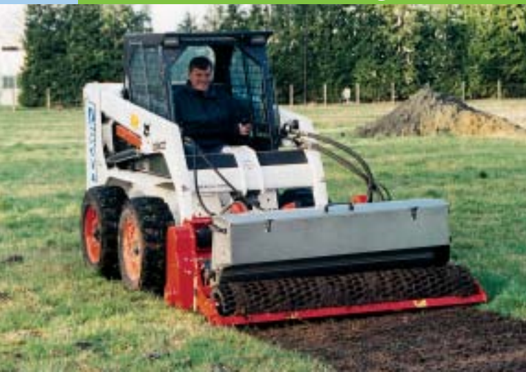
Baumaschinen können mit leistungsfähigen hydraulischen Bodenumkehrfräsen (Kalinke) großflächig und wirtschaftlich Altrasenflächen umfräsen
