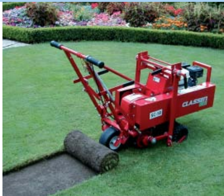
Rasensodenschneider (Kalinke) helfen bei der Erhaltung und Regeneration von Sport-, Spiel- und Zierflächen oder beim Leitungverlegen unterm Grün
