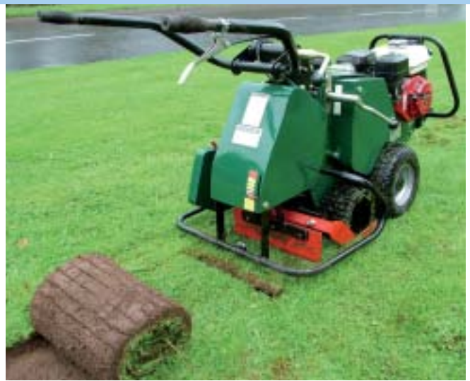
Vielseitige Sodenschneider (Unikom) kann man auf verschiedene Schnittbreiten einstellen. Sie schneiden auf Wunsch auch gewünschte Sodenlängen ab
